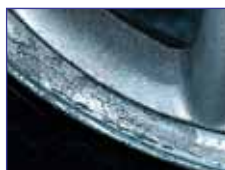
Óxido y Rasgaduras
