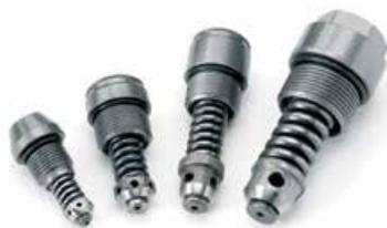
Válvulas de seguridad directamente controladas con función anticavitación. Poseen buenas características de presión junto con unos tiempos de reacción muy cortos. Son compactas, herméticas, fiables e insensibles a la contaminación.
