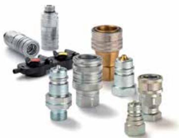
Enchufes rápidos y sistema de multiacoplamiento con mecanismo de bolas para satisfacer numerosas aplicaciones, tales como conexión hidráulica entre accesorios y tractores, maquinaria forestal, cortadoras de césped así como vehículos de servicio en carretera. La mayoría de las series cumplen la norma ISO 7241-1-A y son ampliamente intercambiables. Son utilizados por los principales fabricantes de tractores y maquinaria de todo el mundo.
