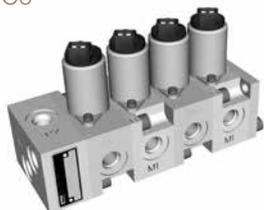
La serie PVC6 es un conjunto de válvula apilable para control remoto de válvulas de control direccional. La válvula proporcional reductora de presión de tres vías crea una presión proporcional en la corriente de entrada. Solenoides disponibles para sistemas de 12 y 24 voltios. La sección de entrada se puede equipar con una válvula reductora de presión para proteger las secciones de control.
