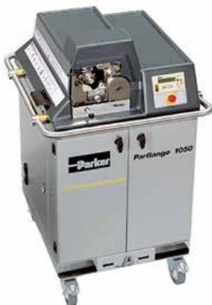
La Parflange® 50 es una máquina de abocardado orbital a 37° y embridado a 180°. Mediante el proceso Parflange® se obtiene una excelente superficie de sellado y una conexión de tubo de alta resistencia.
