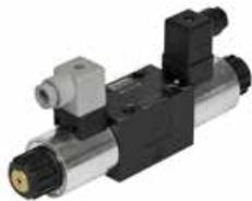
La D1VW es una válvula de control direccional de 3 cámaras controlada eléctricamente con 4/3 ó 4/2 vías. Se activa directamente por solenoides atornillados en armazón lubricado. El cambio suave de la válvula D1VW se consigue amortiguando el émbolo en el tubo con un orificio.
