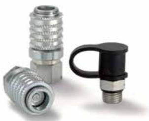
Acoplamientos de diagnóstico que proporcionan tomas de presión de fácil acceso para comprobar el rendimiento de sistemas hidráulicos en plantas o en vehículos móviles. Esta detección precoz contribuye a una mayor eficiencia y vida útil de los equipos. Las series PD y PDP de Parker combinan muchas ventajas: cumplimiento de ISO 15171-1 y SAE J1502 para mayor intercambiabilidad, asiento plano para reducir los derrames, posibilidad de conectar bajo presión.
