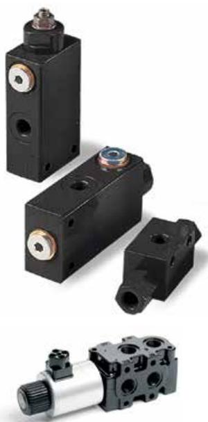
La válvula selectora apilable de Parker se activa por solenoide atornillado en armazón lubricado. La válvula puede conmutar de un circuito a otro en una variedad de caudales y presiones. Cuando deban controlarse más de dos circuitos, se puede apilar unidades adicionales. Alternativamente, la válvula se puede conectar a una bomba y utilizar para dirigir el flujo a uno de dos circuitos diferentes.
