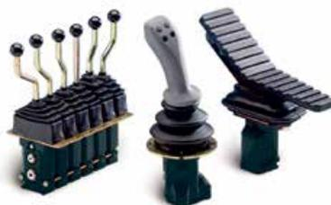
La PCL4 es una válvula de pilotaje hidráulica para control remoto proporcional de válvulas de control direccional, bombas, motores, etc. Está disponible con unidades de palanca joystick así como unidades lineales para control con la mano o el pie.
